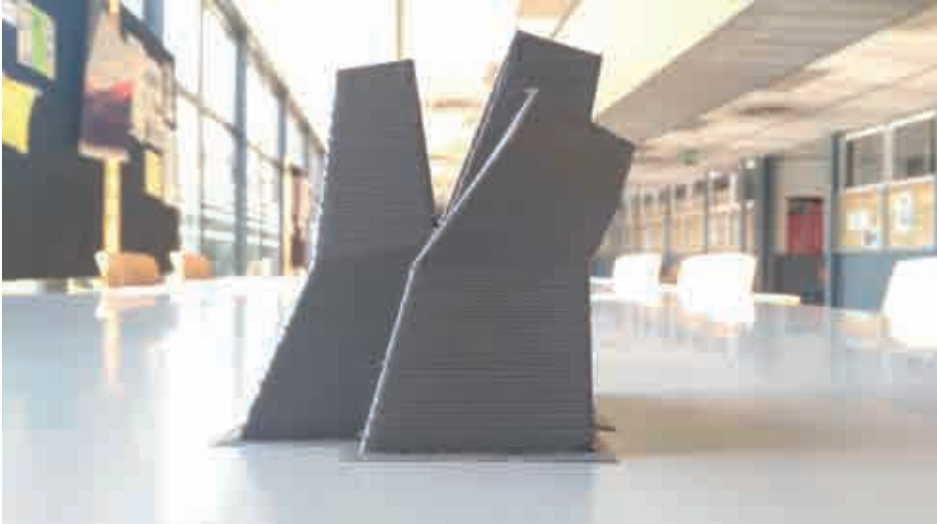
Primera maqueta del panteón simulando los cordones de impresión en hormigón
